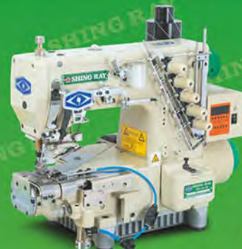
FW-780-TB/FL 横筒型高速三针绷缝机(左刀)
