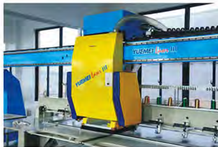
175W桥式激光切割机
